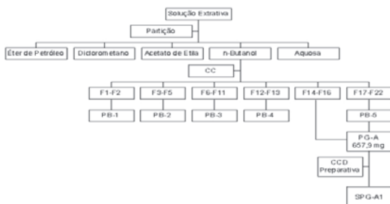
Figura 2 – Esquema do procedimento de purificação por cromatografia em coluna da fração butanólica de P. glomerata
