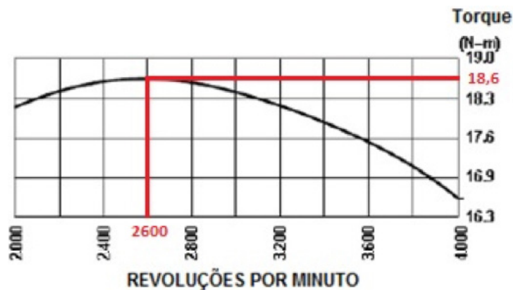
Figura 1 – Curva torque × rotação do motor Briggs Stratton 10 horse power (HP)
