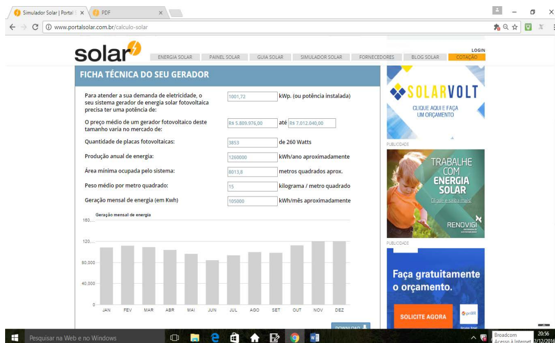
Figura 4 – Dimensionamento e custo de implantação do sistema fotovoltaico na Univille, Campus São Bento do Sul
